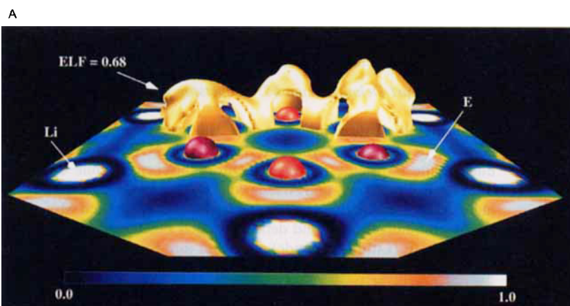
Abb. 2. A: Elektronen-Lokalisierungsfunktion (ELF) für das Anion \text{Si}_6^{10-} in der Struktur von \text{Ba}_4\text{Li}_2\text{Si}_6 (Farbskala: niedrige ELF-Werte sind in dunkelblau, hohe in weiß wiedergegeben). Der Schnitt durch die mittlere Ringebene zeigt die ELF-Maxima ( \text{ELF} \approx 1 ) der kovalenten Si-Si-Bindungen, der n-Elektronenpaare und der Li-Rümpfe (weiß, E = n-Elektronenpaar). An der Form der gelben Isofläche ( \text{ELF} = 0.68 ) erkennt man die ungewöhnliche Beteiligung der n-Elektronenpaare an den Bindungsbereichen und die Polarisierung durch die Li-Atome. B: Zwei Isoflächen mit der Valenzelektronendichte \rho (0.05 bzw. 0.064 \text{ e}^-/\text{au}^3 ) sind mit den zugehörigen ELF-Werten texturiert (Farbskala siehe Bild A). Die Bereiche hoher ELF-Werte der diffusen n-Elektronenpaare liegen bei kleineren \rho -Werten als die der Bindungen. Die Si-Atome sind zur Kennzeichnung ihrer kristallographischen Lagen unterschiedlich farbig wiedergegeben.
